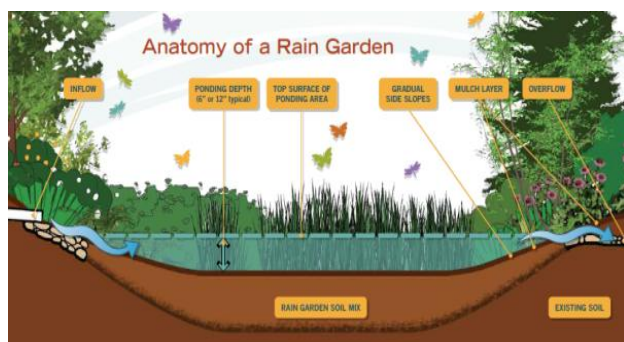
Слика150. Структура кишне баште Извор: https://extension.wsu.edu/raingarden/
