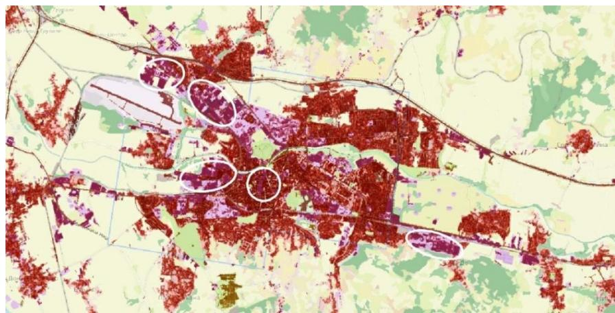
Slika 45. Potencijalno najugroženije oblasti za pojavu UTO na nivou grada Niša na osnovu udela propusnih površina i namene zemljišta
