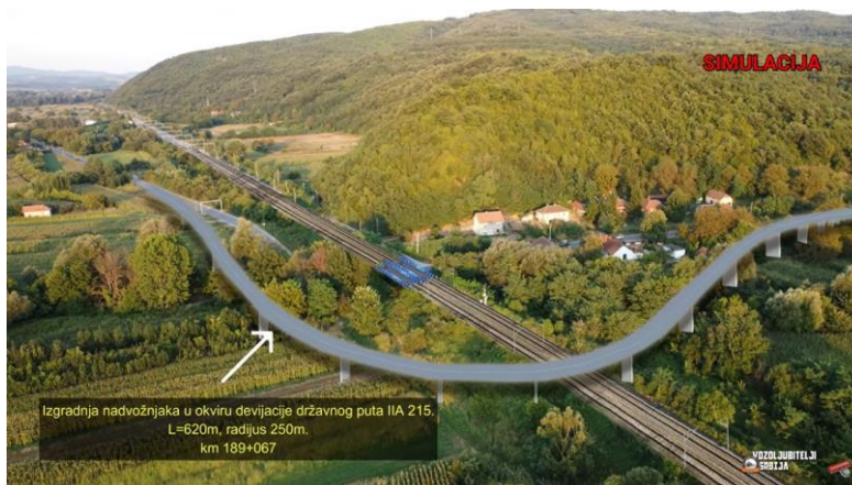
Slika 2: Buduća trasa pruge sa izgradnjom nadvožnjaka u okviru izmeštanja trase državnog puta u naselju Đunis
